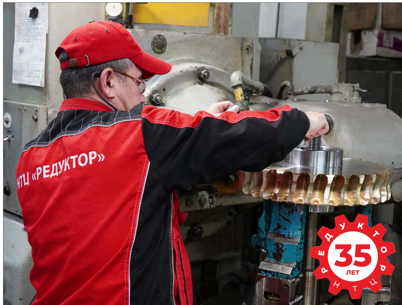
Момент снятия нерезанного червячного колеса с зуборезного станка
