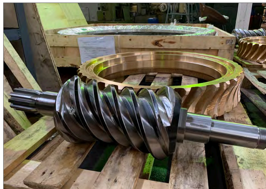
Многозаходный точно отшлифованный глобoidный червяк и бронзовое червячное колесо после их механической обработки
